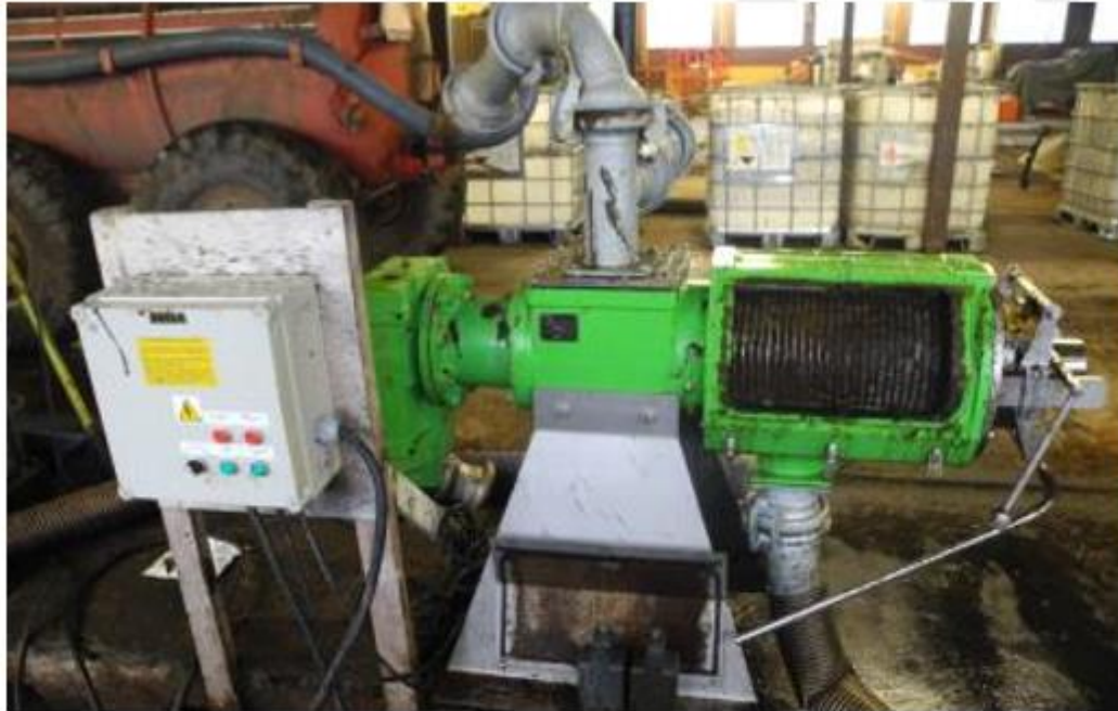
Kuva 1. Luke Maaningan Bauer S655 ruuvipuristinseparaattori. Separoitava liete syötetään laitteen sisään ylhäältäpäin (putki keskellä kuvaa). Nestejäte poistuu seulan läpi (kuvassa 0,5 mm viiraseula ilman kantta) ja putkea alaspäin. Kuivajäte poistuu oikeasta päädyistä, puristuslujuuden säätö tapahtuu lisäämällä painoja päätylevyissä kiinni oleviin ”aisoihin”. Kuva: Arto Pehkonen/Luke Maaninka.
